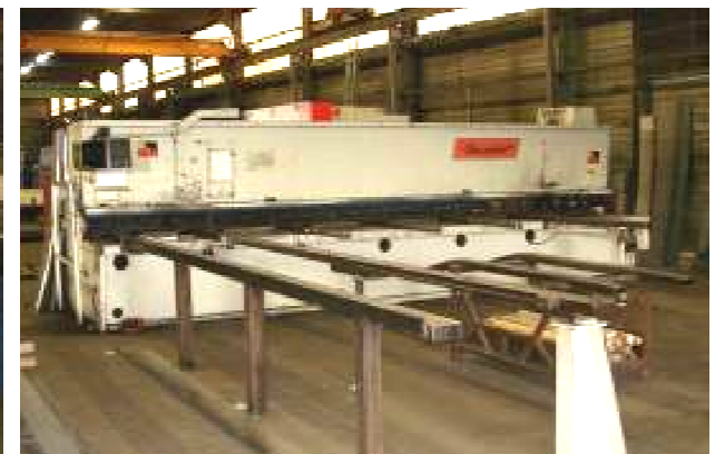
Cisaille numérique Tôles jusqu'à 6,40 mètres
