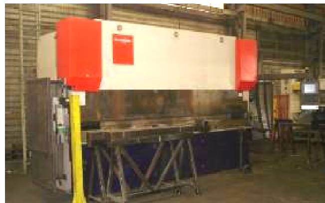
Plieuse numérique Tôles jusqu'à 3,50 mètres
