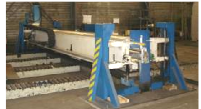
Banc de soudure robotisé Lg 7 mètres
